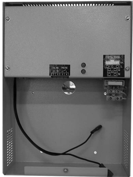
а) б) Рисунок 1.1 – Внешний вид ИБП Штиль PS1205B а) габаритные размеры; б) внешний вид
