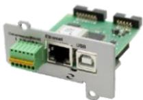
Предназначены для дистанционной настройки и контроля состояния стабилизаторов «Штиль». Устанавливаются во внутренний слот прибора (в моделях напольного/стоечного исполнения). Поддерживают интерфейсы RS-232, USB, mini-USB, «сухие» контакты, Ethernet, RS-485.
