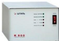
Принцип действия стабилизаторов напряжения с автотрансформатором (релейных, электромеханических, тиристорных и симисторных): при изменении напряжения в питающей сети блоком управления стабилизатора фиксируется разница между фактическим и номинальным его значением. Коммутационное устройство (сервопривод, реле или полупроводниковые ключи), переключается на ту секцию обмотки трансформатора, коэффициент трансформации которой обеспечит наиболее приближенное к номиналу значение выходного напряжения.
