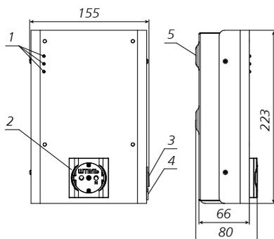
**Рисунок 2а.** Габаритные размеры, компоненты передней и боковой панели стабилизатора Штиль IS350
