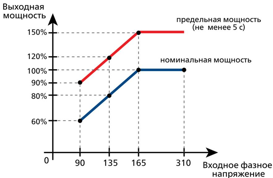
**Рисунок 10.** Зависимость выходной мощности от входного напряжения
